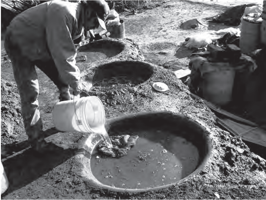
Figura 3. Producción de sal por lavado de tierras en Nexquipayac, Estado de México, marzo de 2006. Fotografía de Blas Castellón
