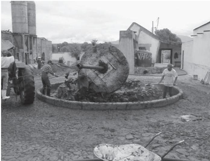
Figura 5. Uso de la tahona o rodillos de piedra para la trititación del agave cocido.
